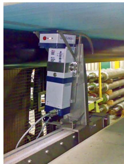
Online-Farbmessung ER 50 PA mit entsprechender Software für die Messung und Regelung
