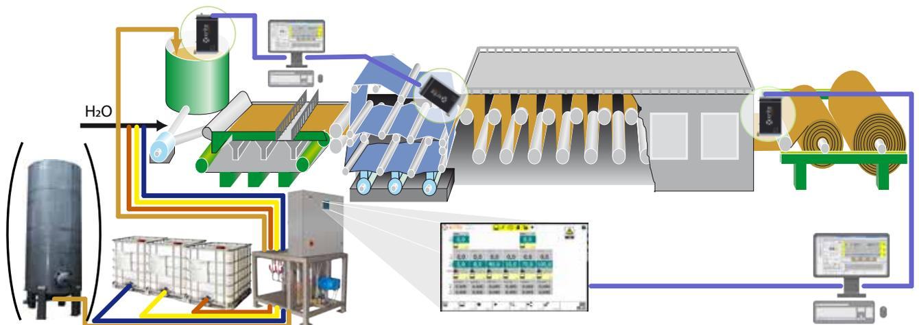
**An der Produktionslinie:** Das Inline-Spektrofotometer ColorXRA 45, das an einem individuell konfigurierten EFX-Messrahmen befestigt ist, und die ESWin Closed Loop Color Control Software
